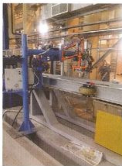
Рис. 14. Установка контроля старогодных рельсов «Авикон-11РСП/ВС» на РСП Московского метрополитена (электродоц «Печатники»)
