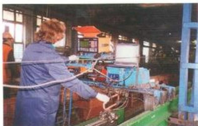
Рис. 11. Дефектоскопический комплекс контроля старогодных рельсов на РСП-21
