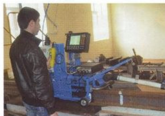
Рис. 6. Дефектоскоп МИГ-УКСМ в Азербайджано на РСП-24
