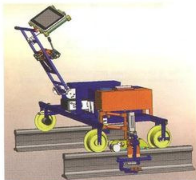
Рис. 13. Установка контроля старогодных рельсов «Авикон-11РСП/ВС» на РСП-29
