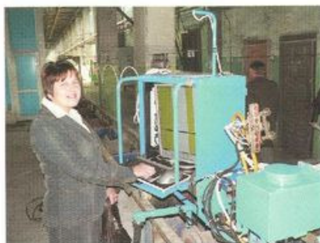
Рис. 12. Установка контроля старогодных рельсов «Авикон-11РСП/ВС» на РСП-31
