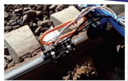
24-канальная схема прозвучивания всего сечения рельса (0°,42°,58°, 70°) для двух нитей пути
